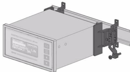
Der HS-ADAPTER-01 dient zur Montage von CIRUS und RESISTRON Fronttafeleinbaugeräten mit Gehäuseabmessungen von 144mm x 72mm (B x H) auf
