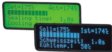
Die mehrsprachige Anzeige der Schweißssparameter (Soll- und Ist-Größen) in Echtzeit oder im Holdmodus erlaubt die Visualisierung der Prozesszustände auf den klar ablesbaren LC- und VF-Displays.
